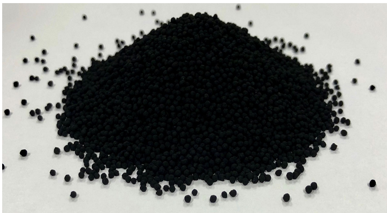
Slika 2: Gotov proizvod Obnovljeni crni karbon u granulama (RCB 2.0)
