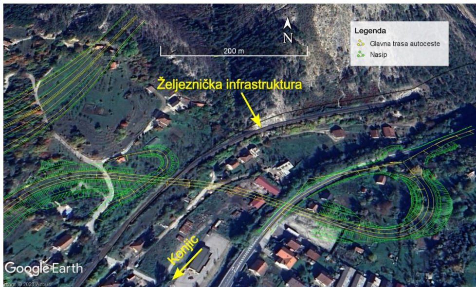
Slika 58: Željeznička infrastruktura presječena vijaduktom između petlje Ovčari i prilaznog puta autoceste
