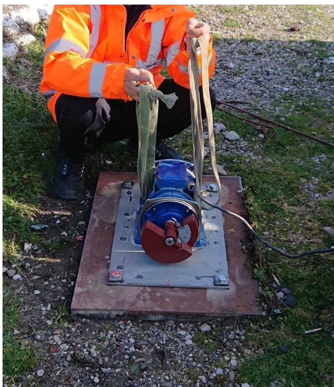
Slika 208: Generator vibracija od 250 kg
