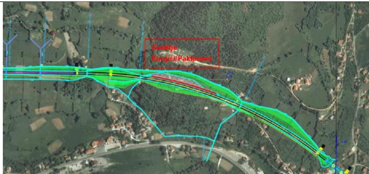
Slika 12 Groblje Runjići/Paklarevo i početak klizišta Runjići (lijevo) u odnosu na trasu brze ceste
