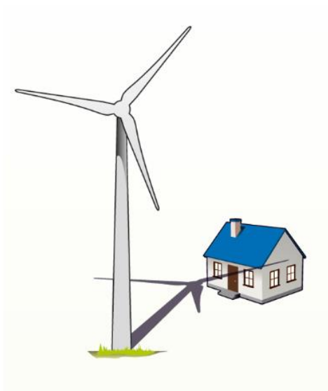
Slika 14 Skica pojave treperenja sjene na receptoru zasjenjenja
