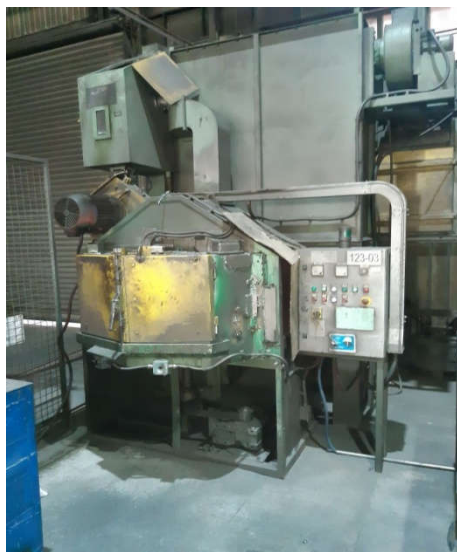
Slika 12. Protočna (kružna) pjeskara
