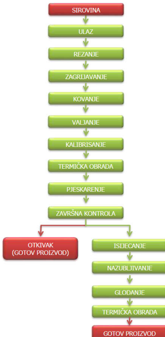
Slika 15. Tehnološka šema proizvodnog pogona
