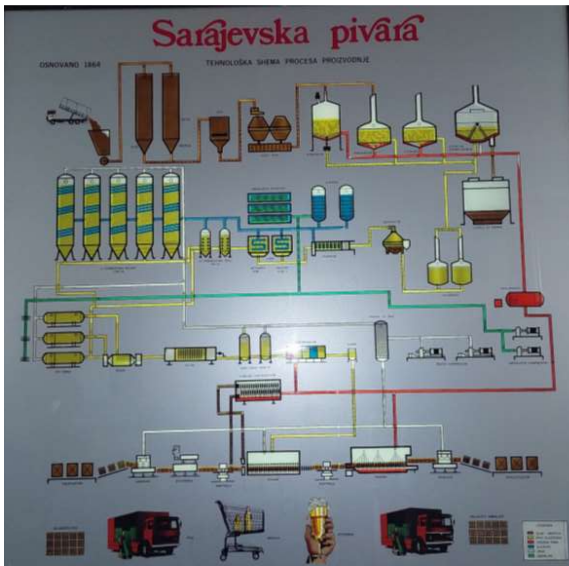
Slika 15. Slikoviti prikaz tehnološkog procesa proizvodnje piva
